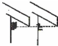
La etapa siguiente consiste en tomar la medida del final de la moldura en “J” hasta el exterior del borde del alero, para el corte de los plafones ranurados (restar 6 mm de luz). Su instalación se realiza colocando una pieza a continuación de la otra verificando el escuadrado de las nervaduras con respecto al borde del techo. Los clavos o tornillos se ubican solamente sobre el borde o cerca del mismo para ser escondidos por el ángulo o moldura de terminación.
