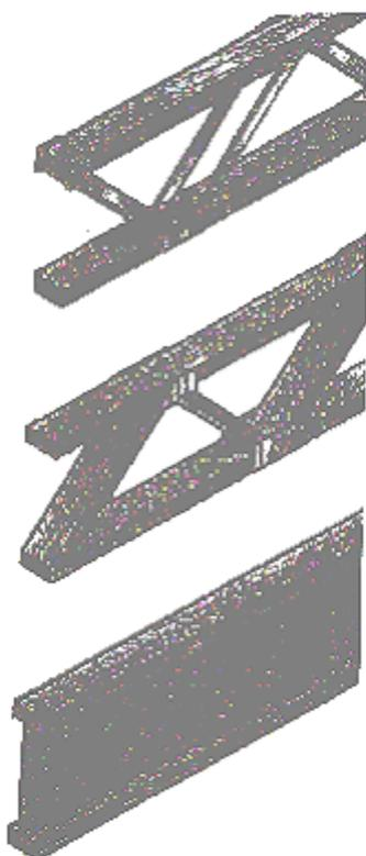
Las vigas tradicionales están hechas de madera de 38 mm de espesor y su altura oscila entre 140 y 286 mm según la carga a soportar, el espacio a cubrir y el tipo y calidad de la madera empleada.
